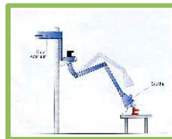
Bras articulé aspirant (positionné à moins de 20 cm de la source d'émission et à l'opposé de l'opérateur) (source INRS)
